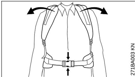
Pro nouzový případ: nacvičte si rychlé otevření spon na bederním pásu (jen SG 71), povolení ramenních popruhů a sejmutí stroje ze zad. Při nácvičku však nikdy stroj neodhazujte na zem, zabrání se tím jeho poškození.
