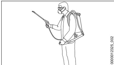
Postřikovač noste na zádech zavěšený na obou nosných pásech – nikdy ho nenoste pouze na jednom rameni.
